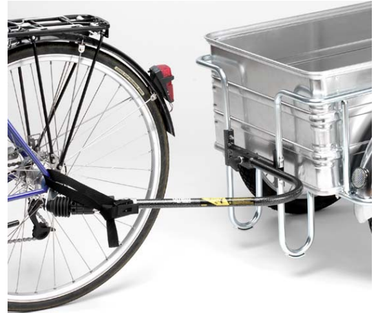
Montage der Weber-Seitendeichsel anstelle der Handdeichsel. Das Modell mit Weber-Kupplung wird seit 2002 geliefert.
