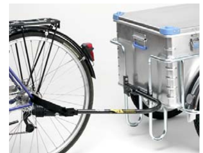
Der Jet-Star-Kurier kann ebenfalls auf die Seitendeichsel umgerüstet werden.
